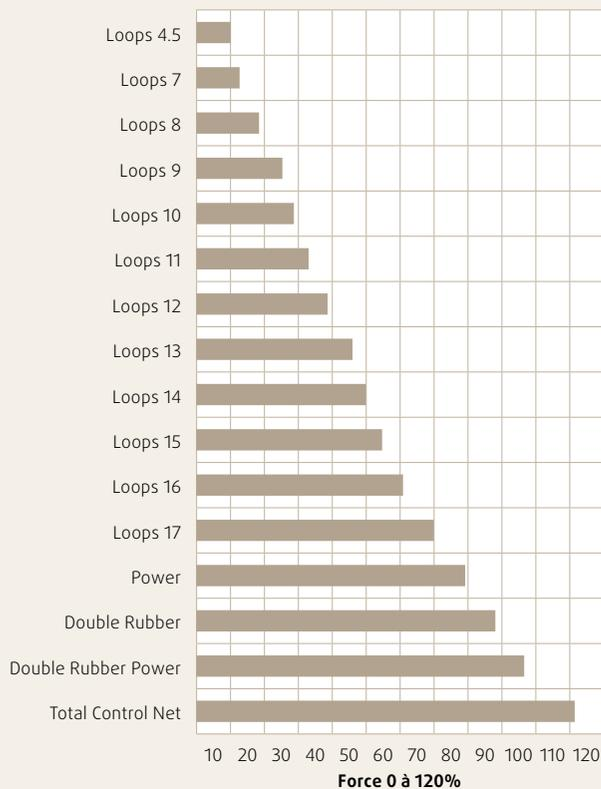
Les spirales sont les fils transversaux que vous pouvez compter lorsque le filet est remonté sur le tube de remplissage. La force décrit l'intensité avec laquelle le produit est ensuite pressé sur la circonférence donnée.
